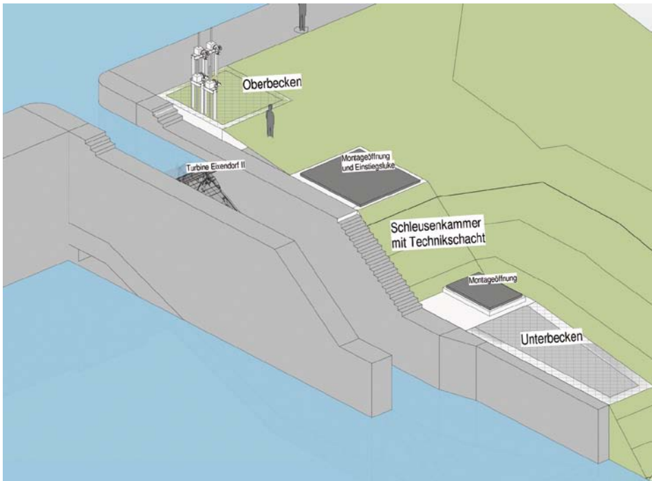
Abb. 5: Die geplante Fischschleuse an der Vorsperre Eixendorf wird landschaftsgerecht in die Uferböschung integriert. Ingenieurbüro Pfeffer, Regen
